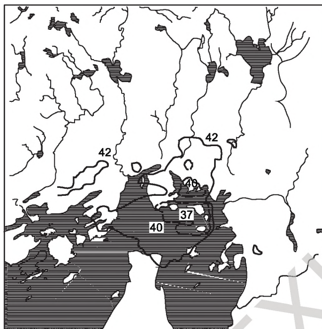
Рисунок С.2 — Моделирование и картографирование срока службы покрытия оцинкованной стали на сетевом уровне в г. Осло в 1994 г., исходя из функций повреждения, выведенных в рамках программы UNECE [42]
