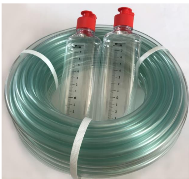
Рисунок Г.11 – Гидростатический уровень
