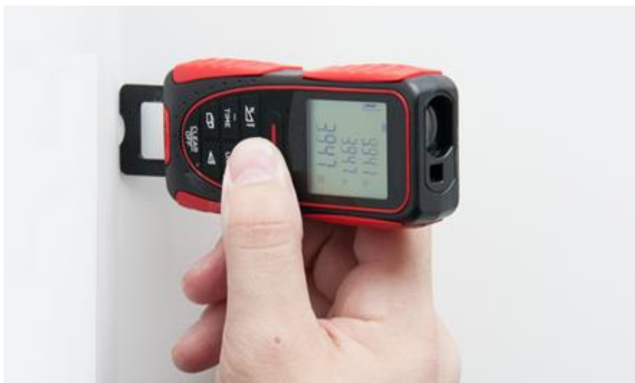
Рисунок Г.10.2 – Измерение дальномером из угла при помощи скобы
