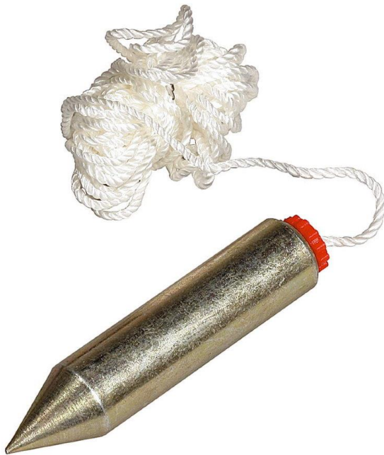
Рисунок Г.6 – Отвес строительный со шнуром
