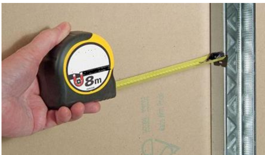
Рисунок Г.8 – Рулетка с магнитным захватом
